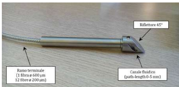
Figura 8: Particolare del probe (parte terminale) del biosensore per misure di fluorescenza in soluzione.
