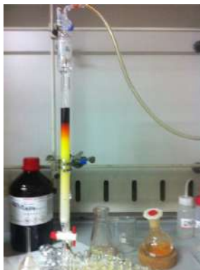
Figura 59: Colonna cromatografica di tipo Flash con eluente in gradiente di polarità (Esano/Acetato di Etile 5:1 -> 4:1 -> 3:1).
